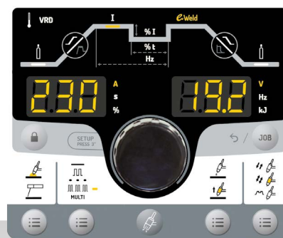
Korisničko sučelje s dvostrukim zaslonom s okretnim gumbom i tipkom za brzo podešavanje parametara
